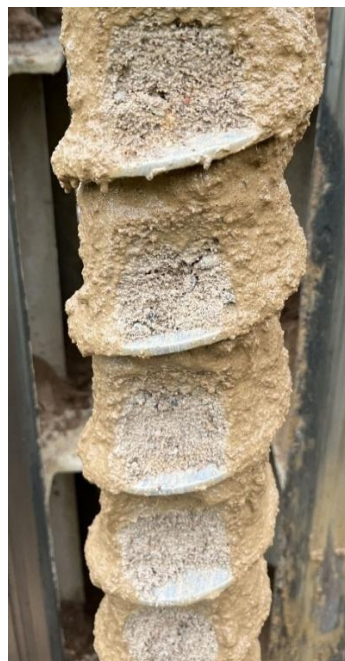
Foto 3.4 Keskmise kuni jämedateraline liiv, Pa-7-25 intervall 7,0-7,4 m
