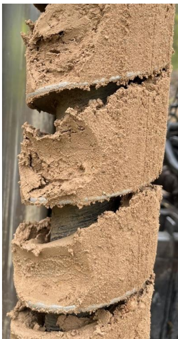
Foto 3.3 Väga peeneteraline savikas liiv, Pa-3-25 intervall 1,2-1,5 m
